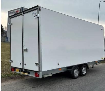
**Caisson en panneau sandwich avec portes-volets à l'arrière**
