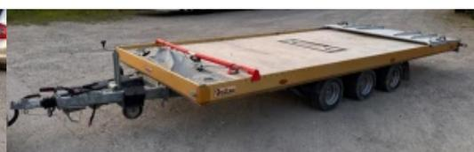
Autotransporter für den professionellen Autotransport. Hydraulisch abklappbare Plattform mit Elektropumpe. Elektrische Seilwinde für ein einfaches Aufladen und lange überfahrbare Heckrampe für einen tiefen Ladewinkel.
