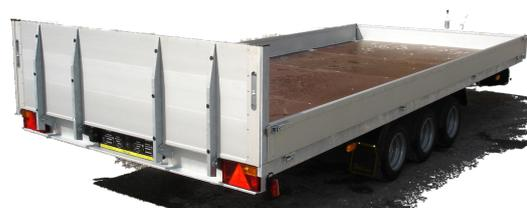
Für den Transport von etwas grösseren Fahrzeuge und Maschinen. Die Ladefläche ist hydraulisch abkippar und die Heckrampe überfahrbar. Serienmässig mit einem Reling ausgerüstet für eine problemlose Befestigung der Fahrzeuge. Bei Bedarf können Seitenladen aus Aluminium zusätzlich montiert werden.
