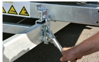
Während Sie bei herkömmlichen Autotransportern mit Auffahrrampen verladen, sind diese beim ATOUR Grande überflüssig. Seine verzinkte Ladefläche ist gleichzeitig eine stufenlos mechanisch kippbare Brücke. Ist er in schräger Auffahrposition kann das Fahrzeug direkt auffahren oder heraufgezogen werden.
