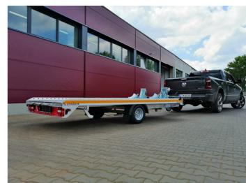
Vollständig aus Aluminium gefertigter Anhänger. Basiert auf KNOTT-Komponenten. Zeichnet sich durch hohe Festigkeit und Zuverlässigkeit aus. Das Anheben der Plattform des Anhängers ermöglicht ein sehr praktisches Beladen von Fahrzeugen mit sehr niedriger Federung.
