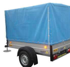
Klassischer Autoanhänger mit Alu-Seitenwände. Einfache und robuste Bauweise für eine lange Lebensdauer. Fahrstabile und leichtzügige Fahrt dank dem tiefen Schwerpunkt und den grossen Rädern. Verschiedene Optionen wie Planen flach und hoch, Bordwanderhöhung oder Polyesterdeckel mit Verschluss sind erhältlich.
