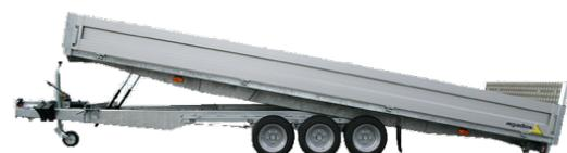
Idéal pour le transport de plus grands véhicules et de machines. Le pont basculant est équipé d'un système hydraulique et la ridelle arrière fait office de rampe de chargement. Equipé en série d'un reling permettant de stabiliser les voitures en toute sécurité. Des ridelles de côté en aluminium peuvent être montées.
