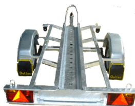
Kleinster und preisgünstigster Scooter und Motorradtransporter mit einer Schiene. Die minimale Lösung für Ihr Fahrzeug: Kleine Abmessungen & tiefe Ladehöhe.
