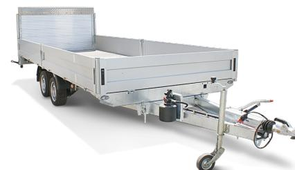
Universal-Anhänger für den Transport von etwas grösseren Ladungen. Die Ladefläche ist hydraulisch abklappbar und die Heckrampe überfahrbar. Er kann als Abschleppwagen dienen oder als Transportwagen für Bau- und Landmaschinen. Praktisch und preisgünstig!
