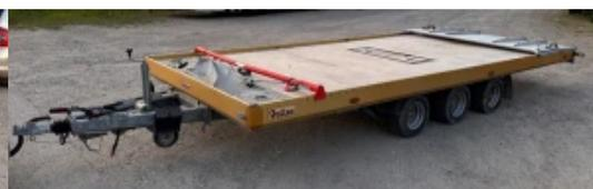
Transporteur de voitures pour le transport professionnel de voitures. Plate-forme à basculement hydraulique avec pompe électrique. Treuil électrique pour un chargement facile et longue rampe arrière carrossable pour un angle de chargement bas.
