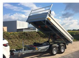
Benne basculante arrière de haute qualité pour le transport de marchandises en vrac de toute nature! La pompe électrique permet une utilisation facile au quotidien. Sa construction robuste garantit une longue durée de vie. Les montants d'angle et les ridelles sont retirables afin de transformer la remorque en plateforme. La ridelle avant est équipée d'une porte échelle et fixe mais peut tout de même être retirée avec les montants. Pour le plaisir de travailler!
