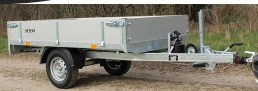
Benne basculante arrière de haute qualité pour le transport de marchandises en vrac de toute nature! Sa construction robuste garantit une longue durée de vie. Les montants d'angle et les ridelles sont retirables afin de transformer la remorque en plateforme. La ridelle avant est équipée d'une porte échelle et fixe mais peut tout de même est retirés avec les montants. Pour le plaisir de travailler!
