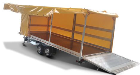
Praktischer Universal-Anhänger für den Transport von etwas grösseren Ladungen. Enthält eine mechanisch abklappbare Ladefläche und zwei Auffahrschienen. Erhältlich in 2 oder 3 Achsen. Ausgestattet mit einer Plane für einen optimalen Schutz. Er kann als Abschleppwagen dienen oder als Transport von Bau- und Landmaschinen.
