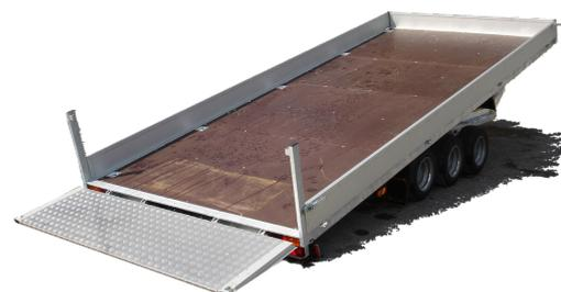
Idéal pour le transport de plus grands véhicules et de machines. Le pont basculant est équipé d'un système hydraulique et la ridelle arrière fait office de rampe de chargement. Equipé en série d'un reling permettant de stabiliser les voitures en toute sécurité. Des ridelles de côté en aluminium peuvent être montées.
