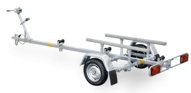
Remorque de loisir, non freinée, conçue pour des Jet-Skis allant jusqu'à 340 kg. Elle est équipée de patins moquettes, rouleaux d'appui et butée d'appui réglables servant à s'ajuster au chargement. La rampe de feux arrière est réglable et démontable. Le châssis zingué à chaud et les roulements étanches garantissent une longue durabilité.
