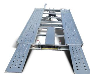
Ideal für den Transport von Klein- und Grossfahrzeuge. Ausgestattet mit einer abkippbaren Ladefläche und zwei Laderampen.
