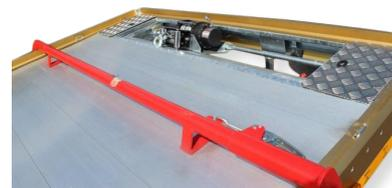
Remorque légère et solide pour le transport professionnel de voitures. Charge utile élevée grâce à la teneur considérable en aluminium. Pont basculant pour un chargement simple et agréable. La rampe est abaissable manuellement et ne laisse qu'un angle de 10°, permettant de charger des voitures rabaissées sans soucis.
