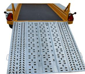
Dieser Anhänger bietet eine sichere Fahrt für alle Arten von Baumaschinen und Baumaterial. Die verstärkten Achsen ermöglichen eine grössere Nutzlast und die durchgehende Gitter-Laderampe sorgt für ein einfaches und schnelles verladen.
