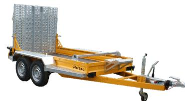
Cette remorque permet de transporter tout genre de machines et de matériel de chantier en toute sécurité. En outre, le chargement se fait rapidement et en toute simplicité grâce à la rampe arrière en grillage acier!
